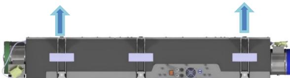
La macchina deve essere fissata al soffitto tramite gli appositi supporti ,deve essere perfettamente in bolla in direzione longitudinale.
