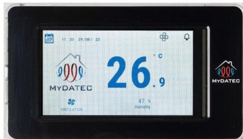
Inserire il nuovo setPoint dell'unità e premere  per confermare. Verificare il ricevimento del setPoint da parte della centrale nella barra a destra della temperatura (indicato dalla freccia)
